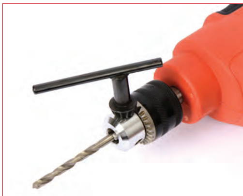
مفتاح الظرف في المثقاب الكهربائي
