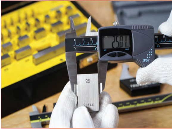
فحص الدقة باستخدام المكعبات المعيارية
