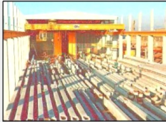
تخزين الوحدات الخرسانية التي تم صبها و تصلدها بطريقة فنية
