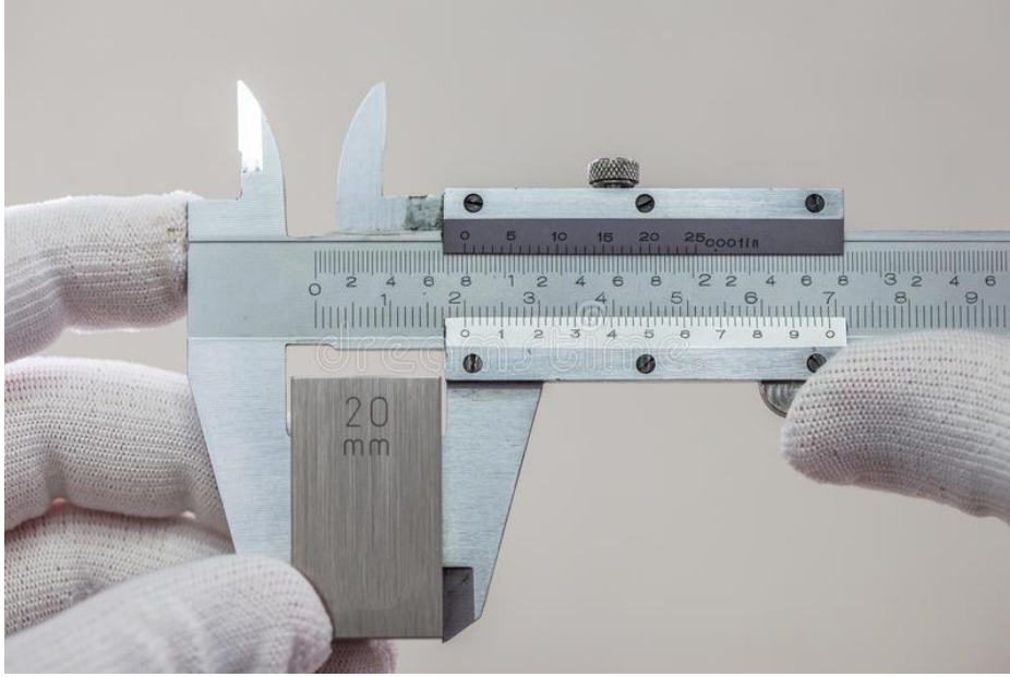
شكل رقم ١٥٨: وضع قالب قياس بين فكي القدمة ذات الورانية
