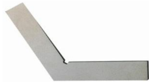
شكل رقم ١٠٨: محدد قياس زاوية منفرجة ١٢°
