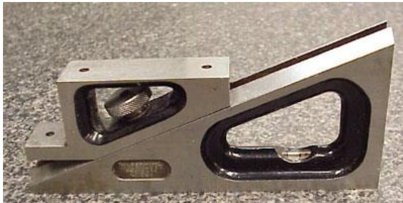
شكل رقم ١٩٥: محدد المستوى لقياس ارتفاع السطح على المقاشط
