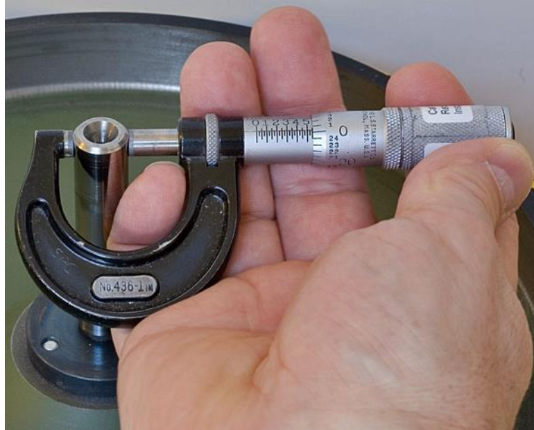
شكل رقم ٩١: الطريقة الصحيحة لاستعمال ميكرومتر القياس الخارجي والقراءة المبينة قيمتها ٠,٥٥٠٥ بوصة ودقة الجهاز هي ٠,٠٠١ بوصة.
