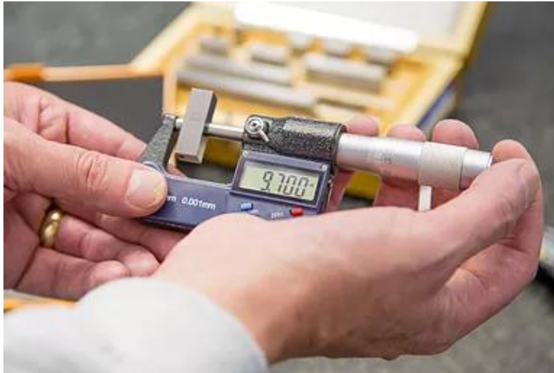
شكل رقم ١٦٠: وضع قالب قياس بين اطراف القياس بالميكرومتر
