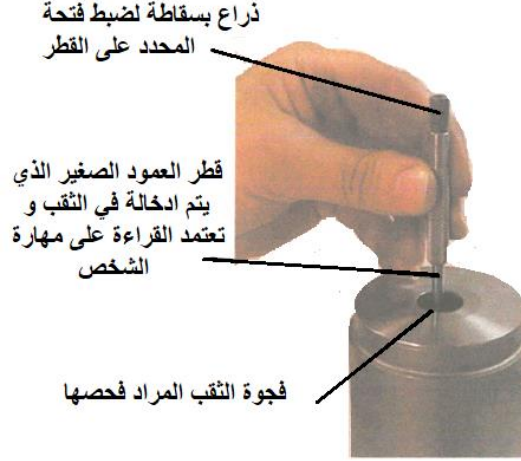
شكل رقم ١٩٩: إدخال محدد الثقوب داخل التجويف
