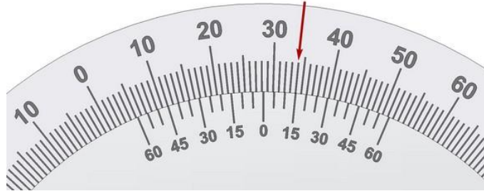
شكل رقم ١٢٥: تدريج الورائبة (القراءة المسجلة ٠٢٨ '١٥)
