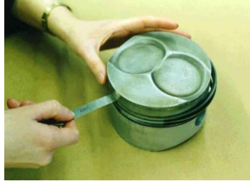
شكل رقم ١٨٧: تحديد سمك مجرى في قطعة ميكانيكية
