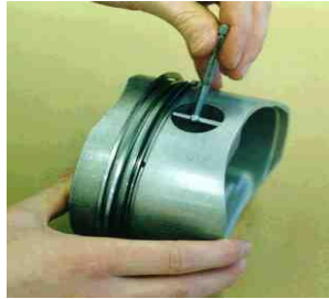
شكل رقم ١٧١: وضع محدث الثقوب بشكل متعامد داخل الثقب
