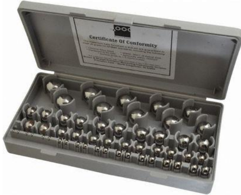
شكل رقم ١٤٦: محددات قياس كروية Gauge ball لقياس السلبية المخروطية
