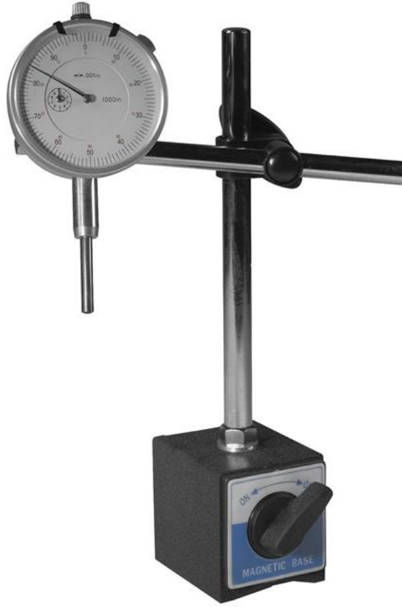
شكل رقم ١٣١: تثبيت ساعة القياس على قاعدة قياس مغناطيسية مستوية
