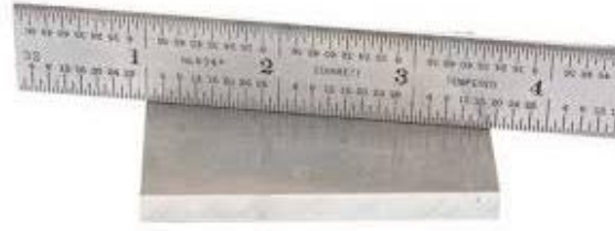
شكل رقم ٣٢: قياس استوائية السطح باستخدام حافة المسطرة
