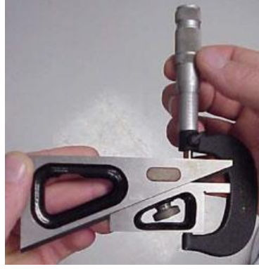
شكل رقم ١٩٦: ضبط البعد المطلوب باستخدام ميكرومتر
