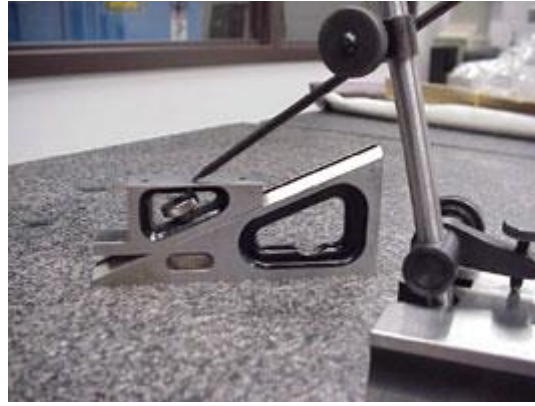
شكل رقم ١٩٧: ضبط ارتفاع شوكة العلام
