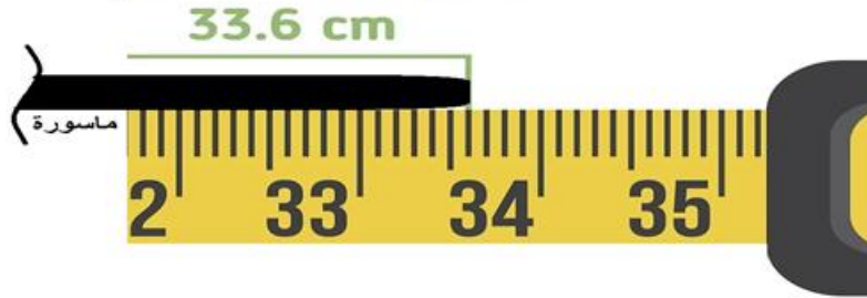
شكل رقم ٢٤: قياس طول الماسورة ٣٣,٦ سم
