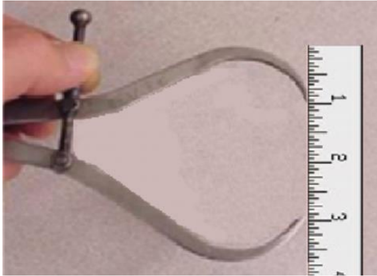
شكل رقم ٣٨: قراءة البعد الخارجي على المسطرة
