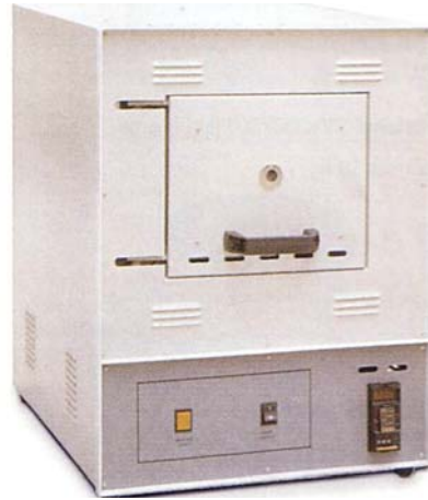
شكل ( ٦ - ٢١ ) فرن كهربائي خاص بالمعالجات الحرارية
