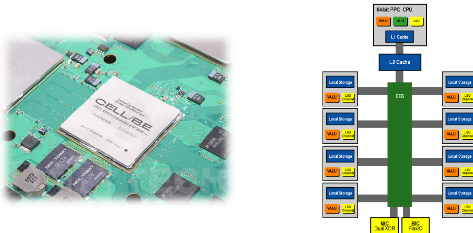
الشكل 25 المخطط الصندوقي للمعالج Cell-Processor
