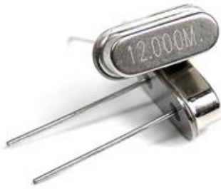
الشكل 14 وصل هزاز كريستالي خارجي مع المتحكم المصغر
