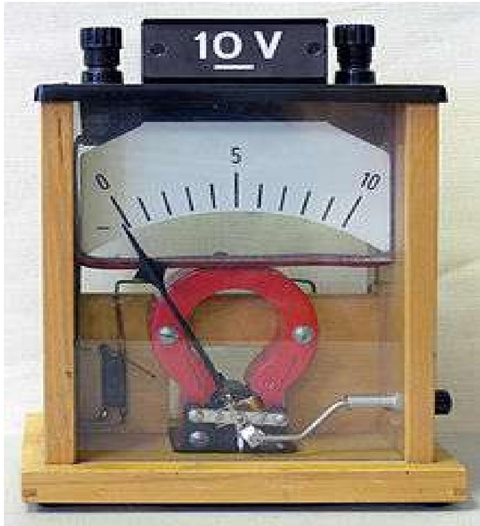
هو جهاز يستخدم لقياس الجهد الكهربائي
