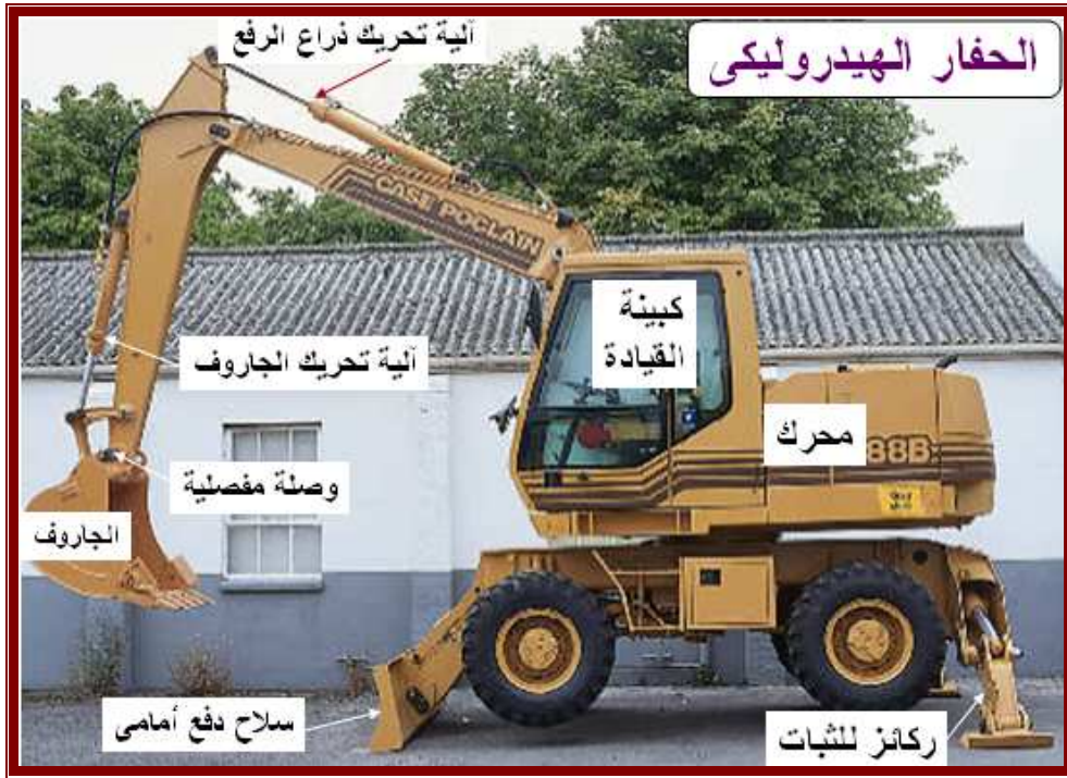
شكل (٦٢-٣): الأجزاء الرئيسية للحفار الهيدروليكي
