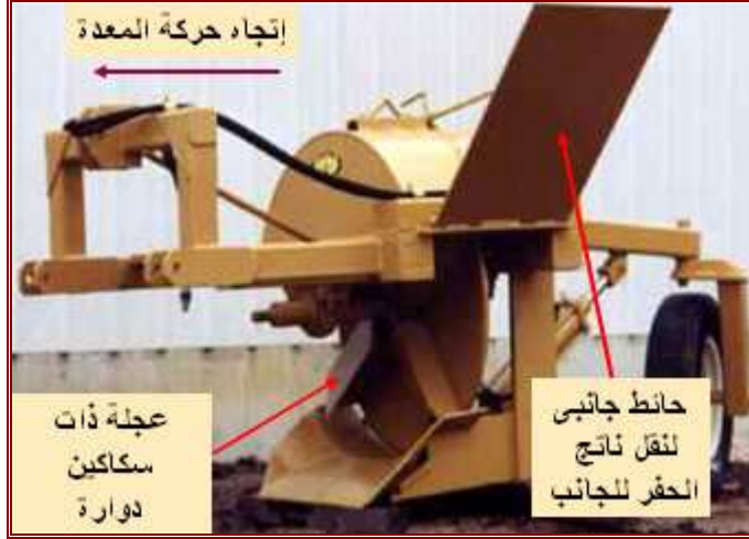
شكل (٣-٧٣): مخندقة ذات عجلة مزودة بسكاكين و حائط جانبي
