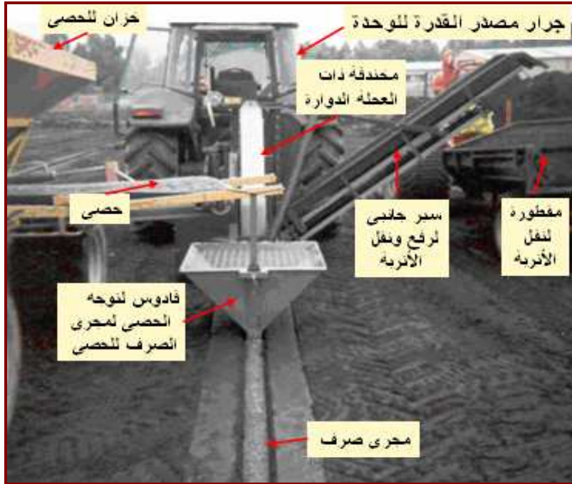
شكل (٣-٧٦): وحدة متكاملة لشق المصارف وملئها بالحصي لتحسين الصرف بالتربة
