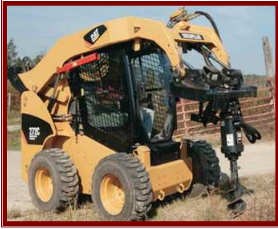
شكل (٣-٤١) إستخدام اللودر فى حفر الجور
