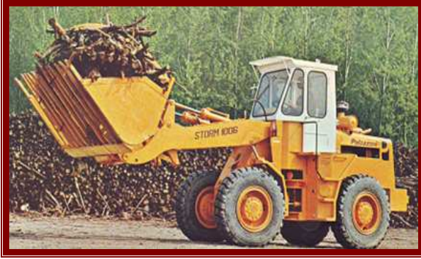
شكل ( ٣-٣٨ ) إستخدام اللودر فى نقل الأخشاب وتشوينها
