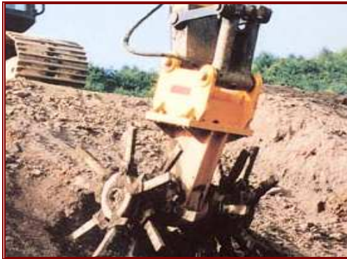
شكل (٣-٦٦ ب): حفار مزود بسكاكين تمزيق التربة
