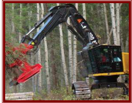
شكل (١٣-٣): تهذيب الشجرة ونزع النموات الجانبية ثم رصها تمهيداً لنقلها
