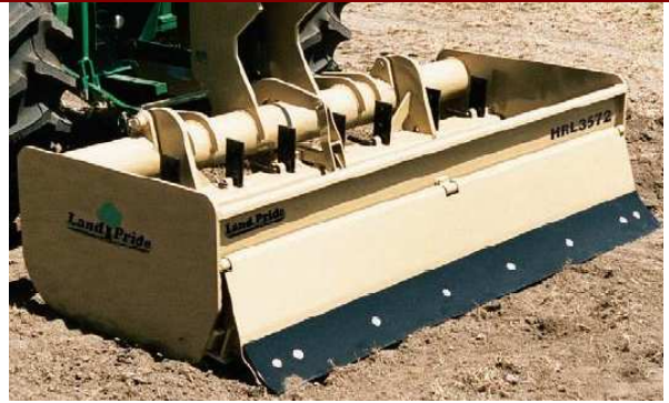
٣- سلاح دفع خلف الجرار مزود بحوائط جانبية تمكّنه من نقل التربة (قصاوية)
