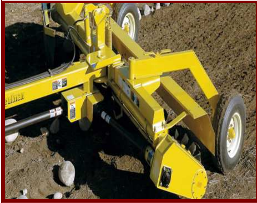
شكل (٢٢-٣): إستخدام معدات دورانية لدفن الأحجار الصغيرة فى بطن التربة
