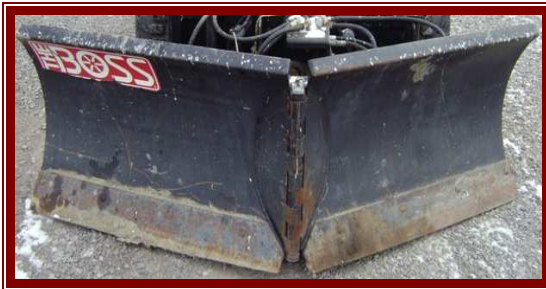
شكل (٢٨ أ-٣): سلاح بلدوزر حاضن للأتربة شكل (٢٨ ب-٣): سلاح بلدوزر لشق القنوات
