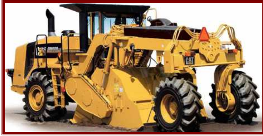
شكل (٣-٦١): رفع هيكل الجرار والقصابية بما يسمح بزيادة حجم صندوق الأتربة
