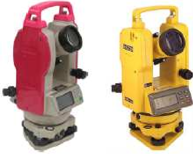
شكل (١٦-١): جهاز التيودوليت الرقمي.
