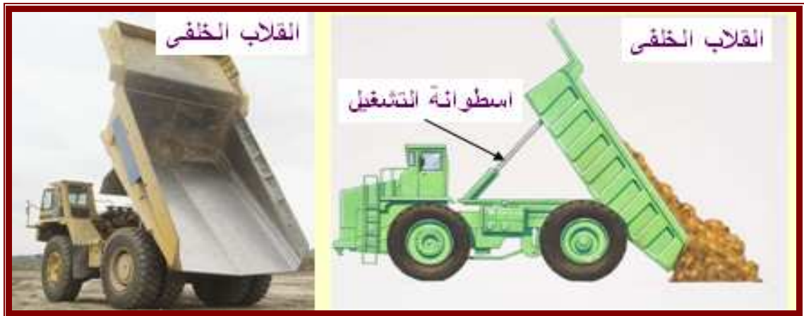
شكل (٣-٤٢) شاحنات ذات تفريغ خلفي
