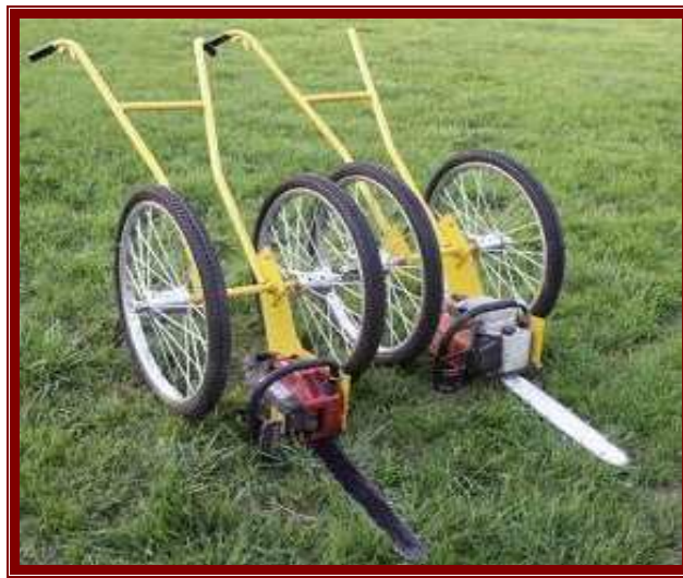
شكل (٣-٨) منشار قطع أشجار يوجه باليد ويعمل بمحرك بنزين
