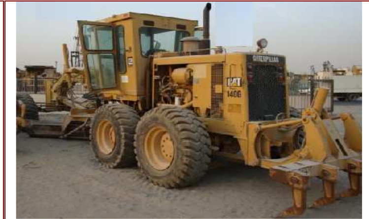
شكل (٦٧-٣): تزويد الجريد بحربة (أسلحة محراث حفار) لتمزيق التربة الصلبة
