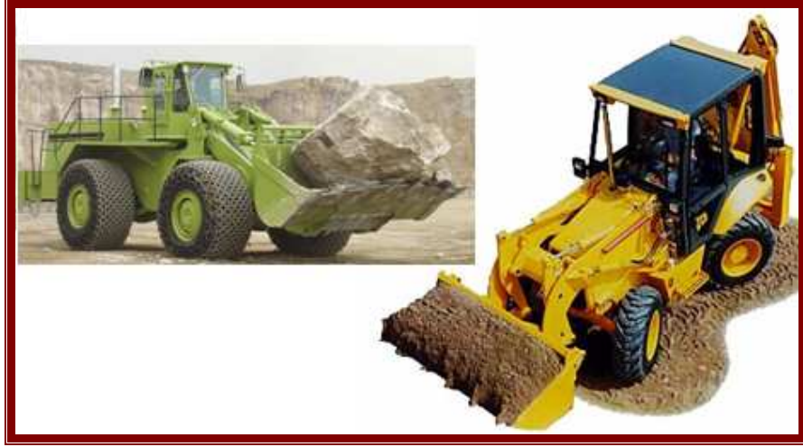
شكل ( ٣-٣٧ ) إستخدام اللودر فى نقل الأتربة والحجارة
