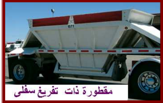
شكل (٤٥-٣) شاحنات ذات تفريغ سفلى
