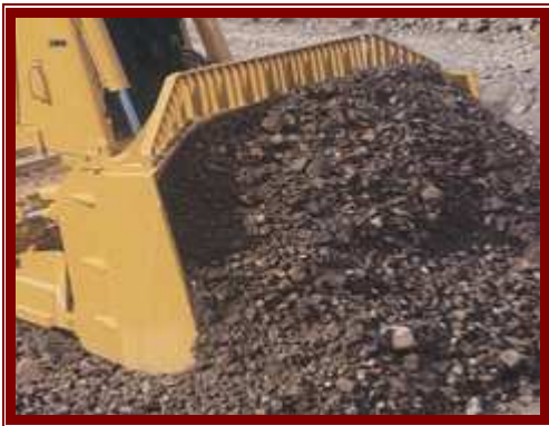
شكل (٣-٢٦): بلدوزر ذو سلاح على شكل حلة لودر
