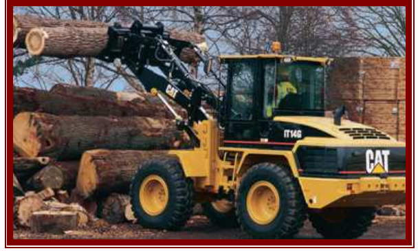
شكل ( ٣-٣٨ ) إستخدام اللودر فى نقل الأخشاب وتشوينها
