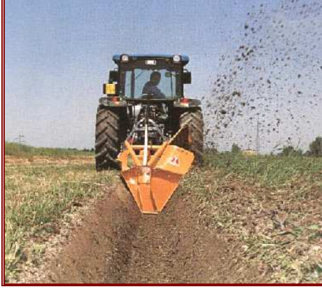
شكل (٣-٧٥): شكل عام للمخندقة ذات العجلة المزودة بسكاكين مائلة على المحيط الخارجي للعجلة أثناء التشغيل
