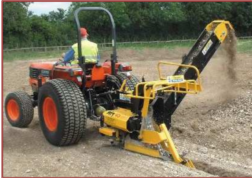
شكل (٣-٧٠): مخندقات ذات سلاسل حفر مزودة بسير جانبي لنقل ناتج الحفر
