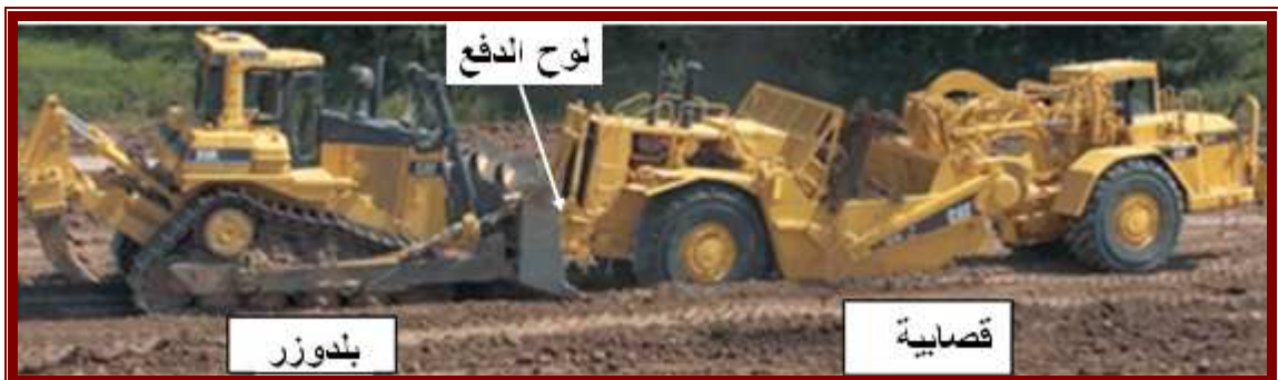
شكل (٣-٥٢): إعطاء قوة دفع إضافية للقصابية عن طريق بلدوزر
