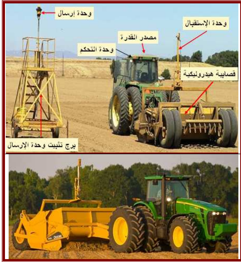
شكل (٣-٨٤): المكونات الأساسية لوحدة للتسوية بالليزر
