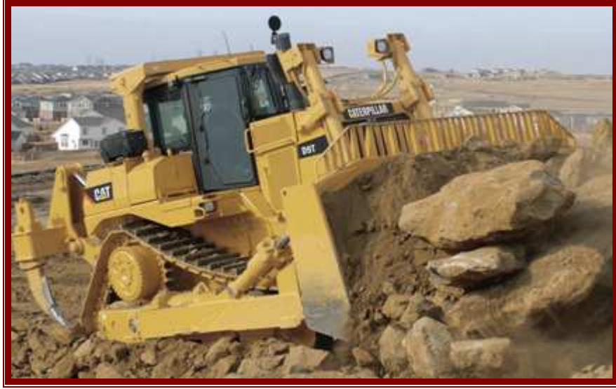
شكل (٣-٢٠): إستخدام البلدوزرات لدفع الأحجار المتوسطة لخارج حدود منطقة العمل
