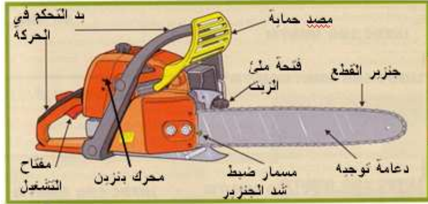
شكل (٣-٧): الأجزاء الرئيسية لمنشار كهربائي يدوي
