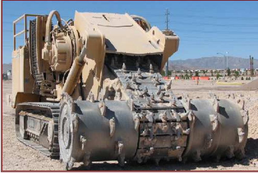
شكل (٧١-٣): مخندقات ذات سلاسل لحفر المجارى المائية العريضة
