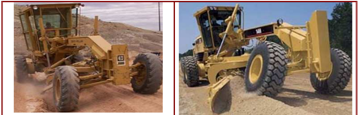
شكل(٣-٦٥): تزويد الجريد بمحاور ذات يايات تمكنها من التعامل مع الميول ليظل السلاح في وضع أفقى
