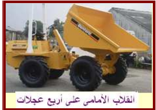
شكل (٣-٤٣) شاحنات ذات تفريغ أمامي
