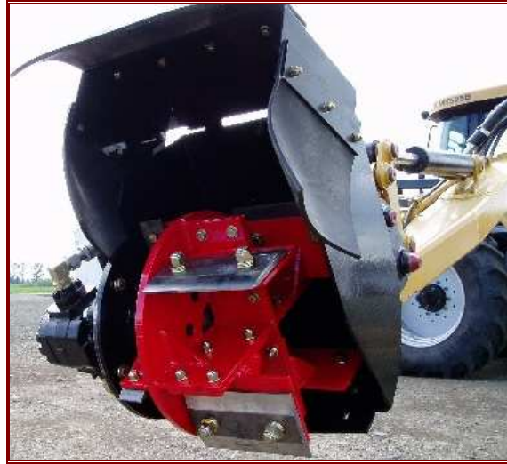
شكل (٣-٧٤): مخندقة ذات عجلة مزودة بسكاكين عرضية وغطاء علوي للحماية
