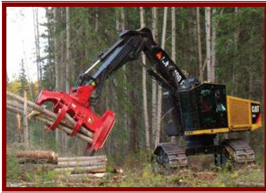
شكل (١٣-٣): تهذيب الشجرة ونزع النموات الجانبية ثم رصها تمهيداً لنقلها
