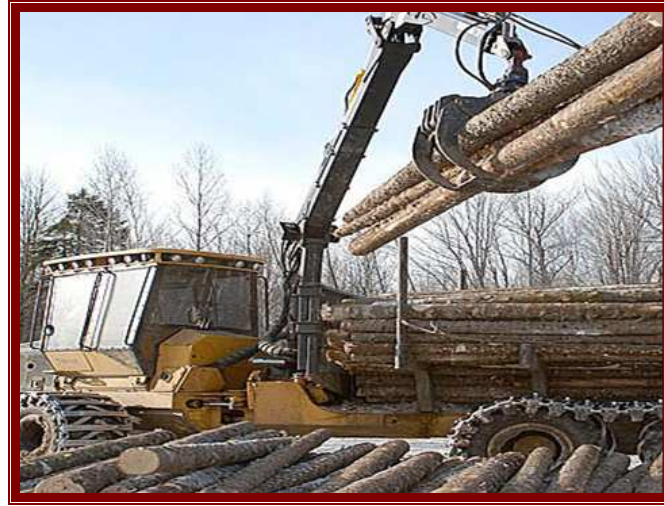
شكل (٣-١٥): إستخدام العربات ذات الأوناش فى نقل الأخشاب خارج منطقة العمل
