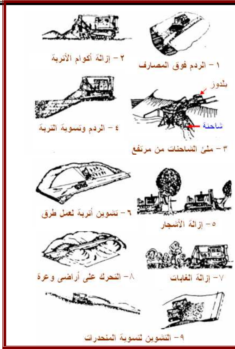
شكل (٣-٢٣): بعض الأعمال التى يقوم بها البلدوزر
