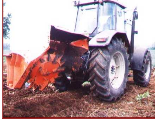
شكل (٣-٧٥): شكل عام للمخندقة ذات العجلة المزودة بسكاكين مائلة على المحيط الخارجي للعجلة أثناء التشغيل
