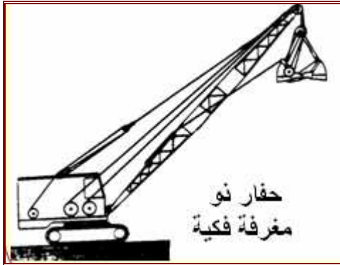
٤- حفار سلكى ذو مغرفة فكية يستخدم لنقل خامات الإنتاج فى شكل دائرى نصف قطره يساوى طول ذراع الحفار.
