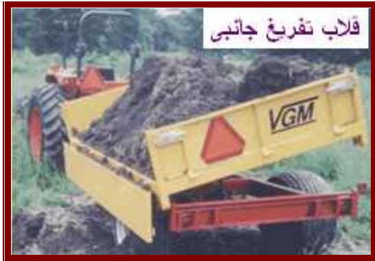
شكل (٣-٤٤) شاحنات ذات تفريغ جانبي
