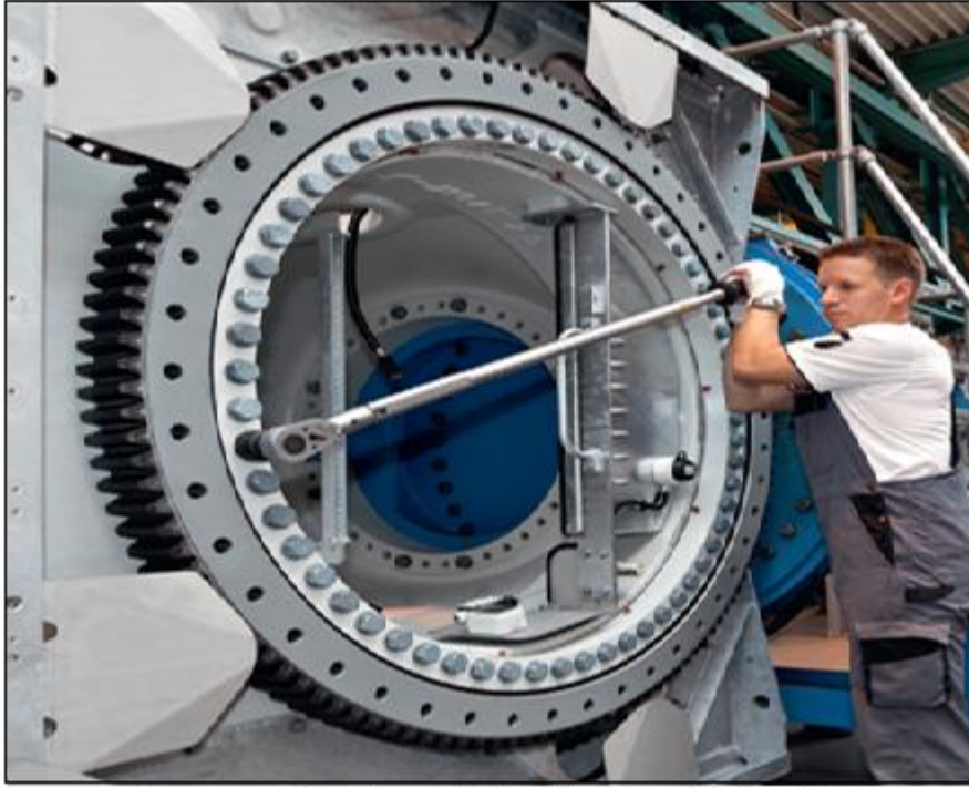
الشكل رقم (١٣ - ب): التثبيت على مسامير التثبيت
