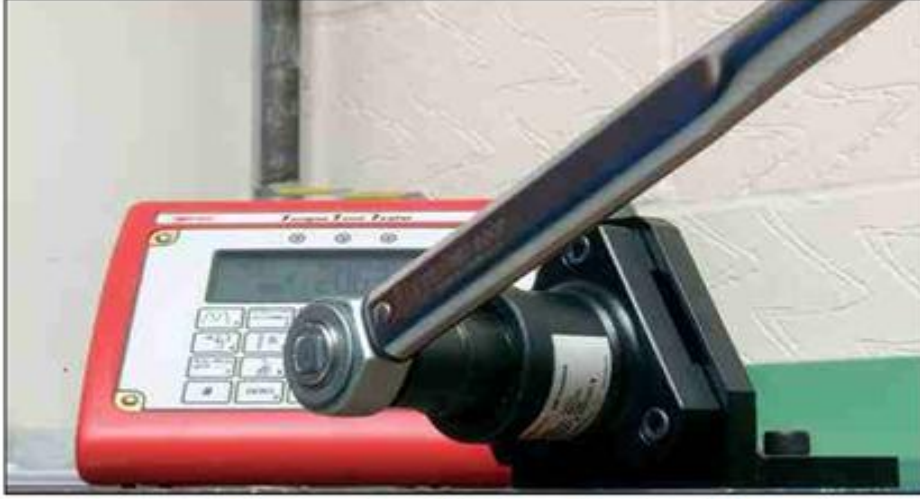
الشكل رقم (٤) : طريقة استعمال مفتاح العزم
