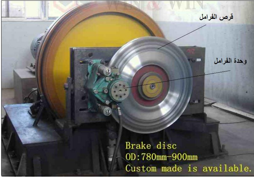
الشكل رقم (٤٠): تركيب الفرامل الميكانيكية
