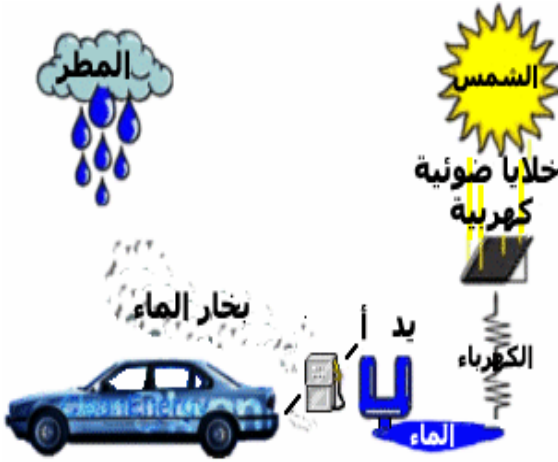
شكل (٥٦): دورة الهيدروجين في تشغيل السيارات
