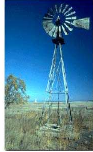
شكل (٣١): توربينة رياح تستخدم في ضخ المياه
