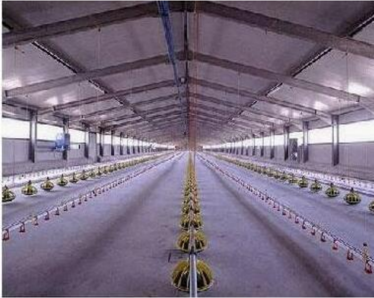
الشكل (9-1) سقف الحظيرة على شكل جمالون وفتحات التهوية
