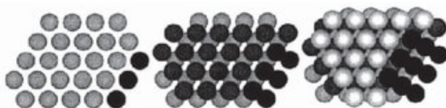
الشكل رقم (٢,٣). الشكل البنائي المكعب المرصوص بإحكام abcabc.
