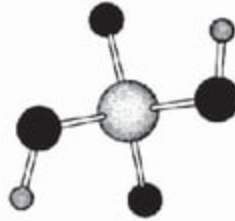
الشكل رقم (٣،١٣). الشكل البنائي لحمض الكبريتيك في الطور الغازي.
