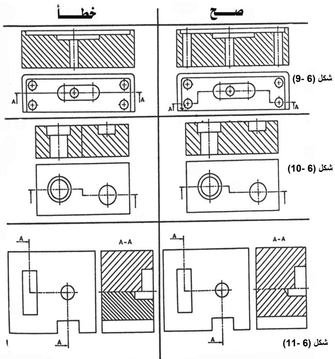
ز - الأجزاء التي لا تقطع أو لا تهش عن قطعها شكل ( 6-12 ) تجرى لها عملية قطع للزيادة في التوضيح ، غير أن هناك أجزاء إذا تم قطعها لا تؤدي إلى التوضيح بل تؤدي إلى الغموض وسوء الفهم . ويمكن مشاهدة بعض الأمثلة لذلك في التالي :
