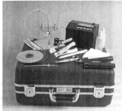
الشكل 6-34 عدة ربط الليف بالغراء. عبر تذيب الغراء من خلال التسخين (تقدمة (AURIGA (europe) PLC
