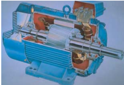
■ مقطع داخلي يوضح مكونات محرك حثي ملفات جزئه المتحرك على شكل قفص السنجاب.
