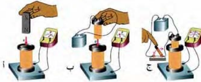
الشكل (١٨): مبدأ توليد القوة الدافعة الكهربائية
