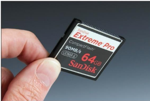
الشكل (7-11) بطاقة الذاكرة فلاش
