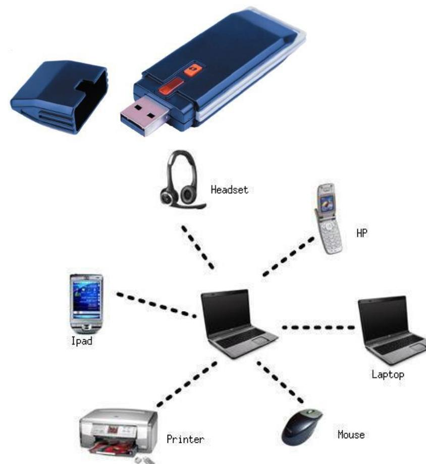
شبكة المنطقة المحلية اللاسلكية يشار إليها عادة بالشبكة المحلية اللاسلكية **Wireless LAN (WLAN)**، تستخدم الترددات الراديوية لتوصيل أجهزة الحاسب وغيرها من الأجهزة، جميع الاتصالات تمر عبر نقطة الوصول أو نقطة النفاذ اللاسلكية المتموضع في موقع مركزي من الشبكة **wireless access point** أو **محطة القاعدة Base station** نقطة الوصول هذه تفسر ترددات الراديو الواردة وتوجه الاتصالات إلى الأجهزة المناسبة.
