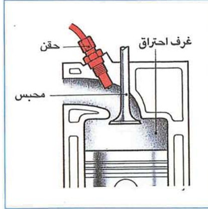
● شكل (٤) موضع حقن الوقود في طريقة الحقن التوقيتية .
