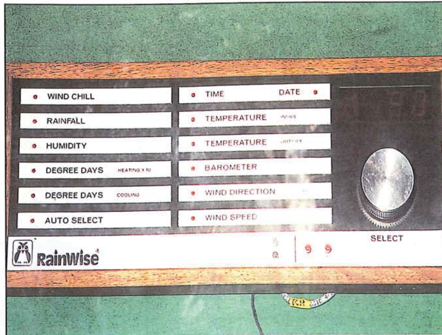
● جهاز قياس عوامل المناخ المختلفة (الحرارة والضغط والرياح والأمطار والرطوبة) .
