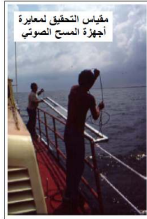
شكل (٣-٣) مقياس التحقق لأجهزة الجس الصوتي أحادي الشعاع
