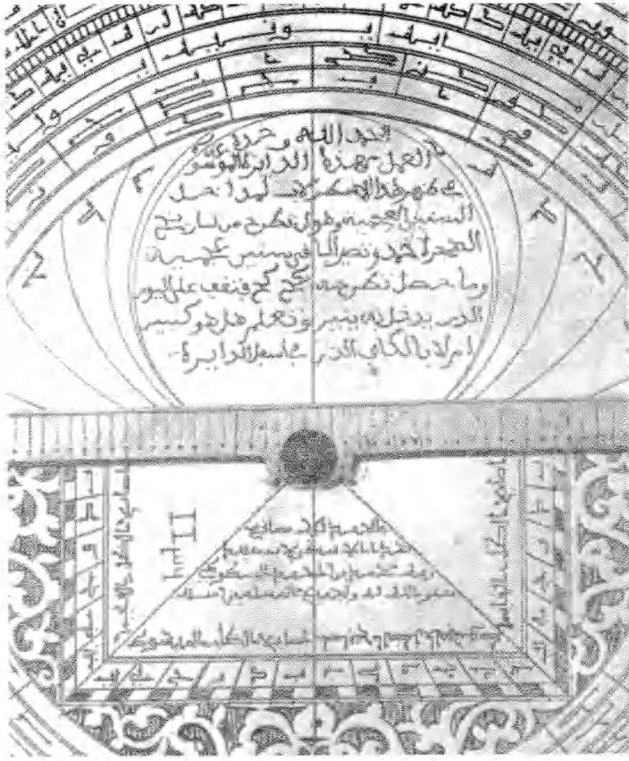
(شكل ٦-٢٣) أسطرلاب مزود بجزء لتحويل التقويم، مستوى السطح، مصنوع من النحاس الأصفر، مراكش - القرن الثامن عشر
