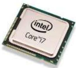
يعد واحد من أهم المكونات في الحاسوب ويتم معالجة البيانات فيها. فهو يحدد سرعة تشغيل الحاسوب وتقاس سرعة بـMHz. ويقوم الحاسوب بكل العمليات التي تتم داخل الحاسوب.
