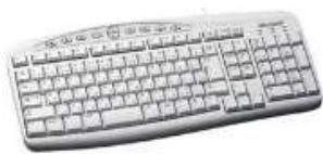
هي لوحة أساسية تتكون من أزرار لإدخال البيانات إلى جهاز الحاسوب عن طريق أزرار. ونكتب هذه الأزرار أحرف أو أرقام أو رموز. وتعتبر لوحة المفاتيح أكثر وحدات الإدخال شيوعاً واستخداماً.
