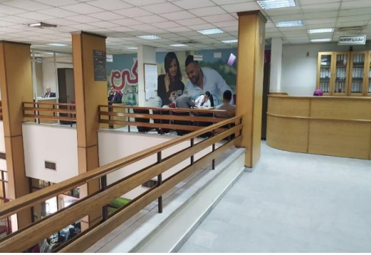
شكل (5.27): استخدام الرخام للأرضيات وكسوة الحوائط بالاختشاب
