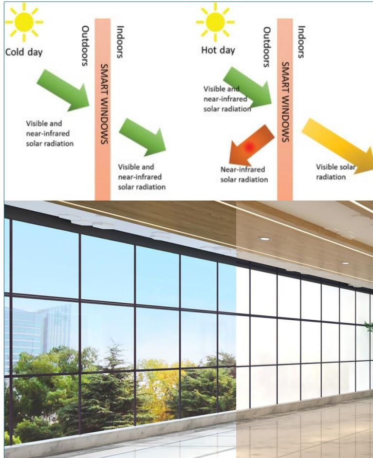
المواد الترموموكرومية هي المواد التي تتغير لونها أو شفافيتها مع التغيرات في درجة الحرارة. تستخدم بشكل متزايد في الهندسة المعمارية والتصميم الداخلي لإنشاء أسطح ديناميكية وتفاعلية. على سبيل المثال، يمكن استخدام الزجاج الترموموكرومي لإنشاء واجهة تتغير لونها تبعًا لدرجة الحرارة في الخارج، في حين يمكن استخدام ورق الحائط الترموموكرومي لإنشاء بيئة تحسين المزاج يستجيب للحرارة الجسدية.
