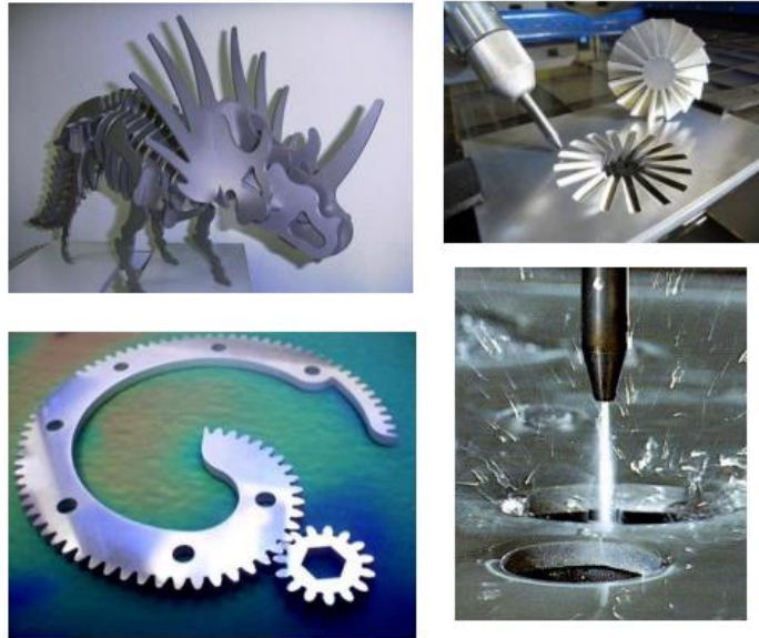
مجموعة من الصور توضح استخدام ماكينات الـ (Water jet) في تقطيع و تشكيل المعادن
