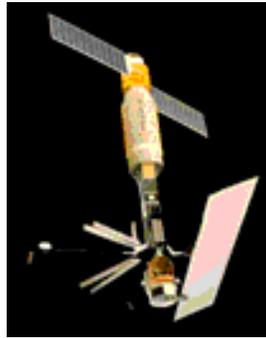
أطلقت وكالة الفضاء الاوروبية نظام ERS-1 في عام ١٩٩١ حاملا جهاز قياس الارتفاعات الرادارية radar altimeter وجهاز قياس الاشعة تحت الحمراء و الموجات القصيرة infrared and microwave sounder وأيضا جهاز رادار يعمل في النطاق C (٥.٦٦ سنتيمتر). ومن ثم فيستطيع هذا النظام قياس الانعكاسات من سطح المحيطات وأيضا قياس سرعة و حركة الرياح السطحية. ويمكن للنظام أن يعمل كمنفذ صناعي SAR لتجميع البيانات في مسار عرضه ١٠٠ كيلومتر بزوايا سقوط بين ٢٠ و ٢٦ درجة وبدرجة وضوح مكانية تبلغ ٣٠ متر تقريبا.
