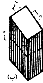
شكل رقم (٢٣) اتجاه عمل الألياف وتأثيره على القوة
