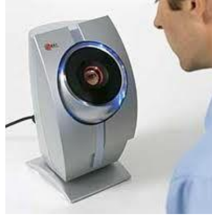
الشكل (6-15) نماذج عن قارئات بيومترية قارئ القرنية Iris reader، قارئ بصمة الاصبع Fingerprint reader
