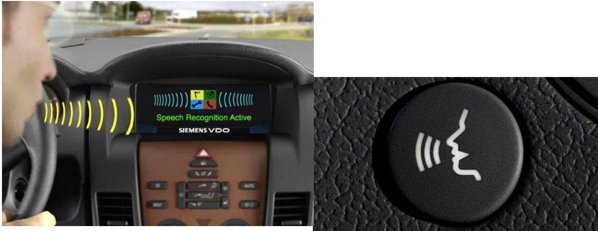
الشكل (6-18) نظام تعرف على الصوت في السيارة
