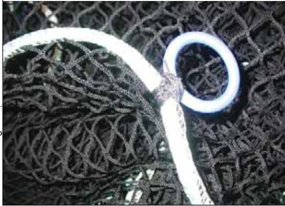
اللوحة 69 زِمَامٌ مُنْزَلَقٌ على قاعدة شَبَكٍ لِقْفَصٍ (أربطة أسلاك إحكام التثبيت ليست مركبة بعد)
