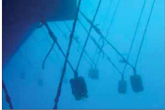
اللوحة 33 أكياس شبكية مملوءة بالرمل والحصى أو الأحجار الصغيرة للاستخدام كمُغْرِقات موازنة
