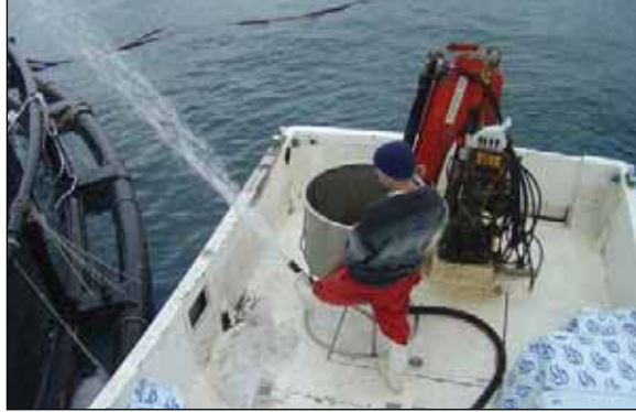
اللوحة 109 قارب مجهز بمدفع غذاء نصف آلي. في هذه الحال المدفع مجهز بقادوس ضخّم لتخزين كثير من الغذاء. تُضَبَط الكمية الواجب نثرها من الغذاء على كل قفص من قبل ربان القارب الذي يستخدم أداة تحكم الكترونية على البرج
