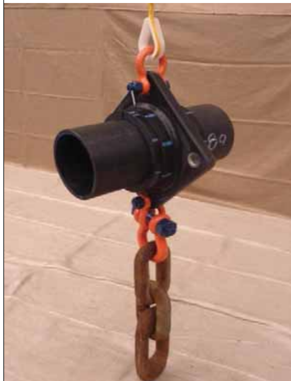
اللوحة 37 عنصر HDPE لوصل أنبوب الإغراق. يُظهر هذا النموذج كيف يُثَبَّت أنبوب الإغراق (ممثلاً بقطعة من الأنبوب) على حبل المُعْرِق (بالأصفر مع حلقة لَدَنِيَّة)، وكيف يمكن إضافة مُعْرِقات أخرى (كالسلسلة كما هو موضح). يمكن استخدام الثقب الحر المتبقي كنقطة ربط للشبك
