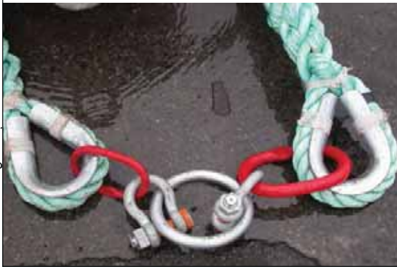
اللوحة 18 خواتم فولاذية مستخدمة لوصل حبلين ذوي جديلة عينية بحلقاتٍ من خلال زوج من الأصفاذ. صفاذ آخر يربط الخاتم الدائري بالصفائح الزاوية
