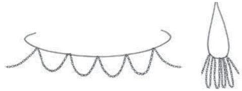
الشكل 14 يمكن أن تُحرَم السلاسل بإيلاج حبلٍ في حلقات تفصل الواحدة عن الأخرى 20-30 حلقة من حلقات السلسلة لإتاحة المجال لتداول أسهل بواسطة رافعة شوكية أو رافعة عمودية
