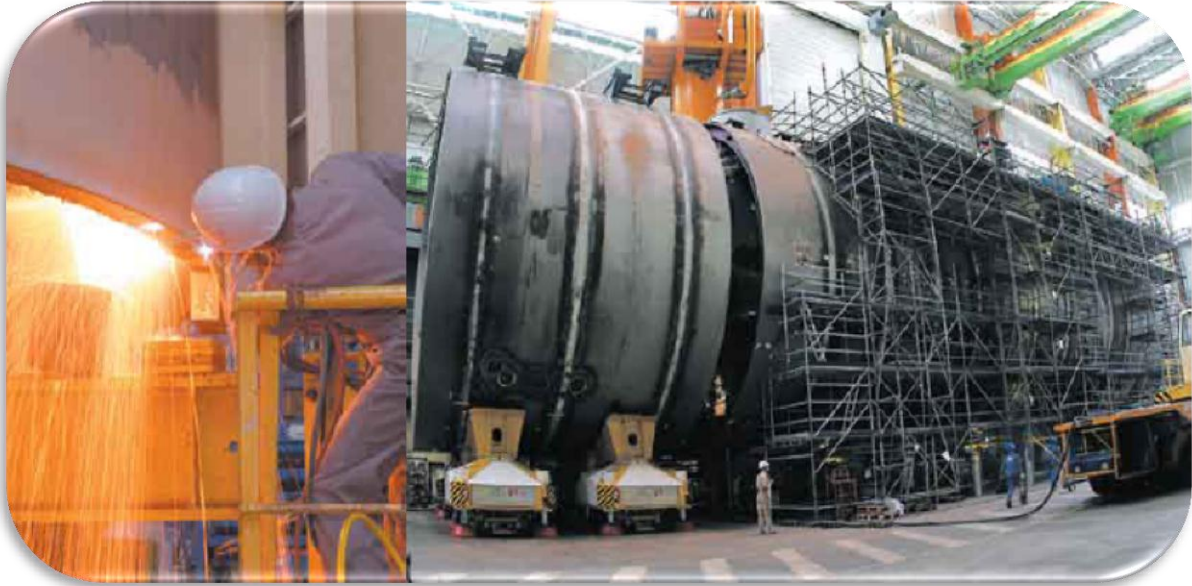
شكل (٣٢) صورة تبين ورشة عمل الغواصة الفرنسية سكوربيون وعملية تصنيع هيكل الضغط باللحام.
