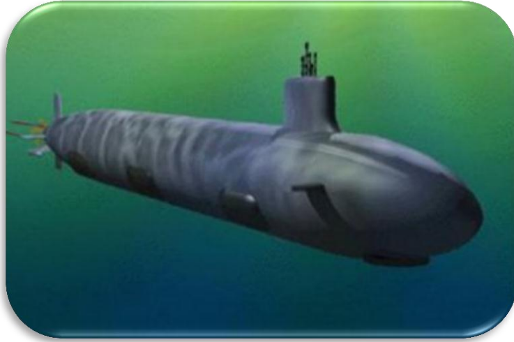
شكل (١) صورة تظهر الشكل الاسطواني للغواصة مع النهايات المستدقة والبرج ( الغواصة فيرجينيا SSN 774 )
