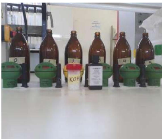
الصورة (10): الأدوات المستعملة في قياس DBO_5
