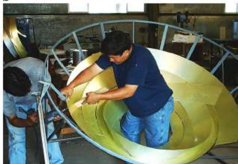
شكل (5-8) : ربط الانعكاسات على الهيكل. (Franco et al., 2004)
