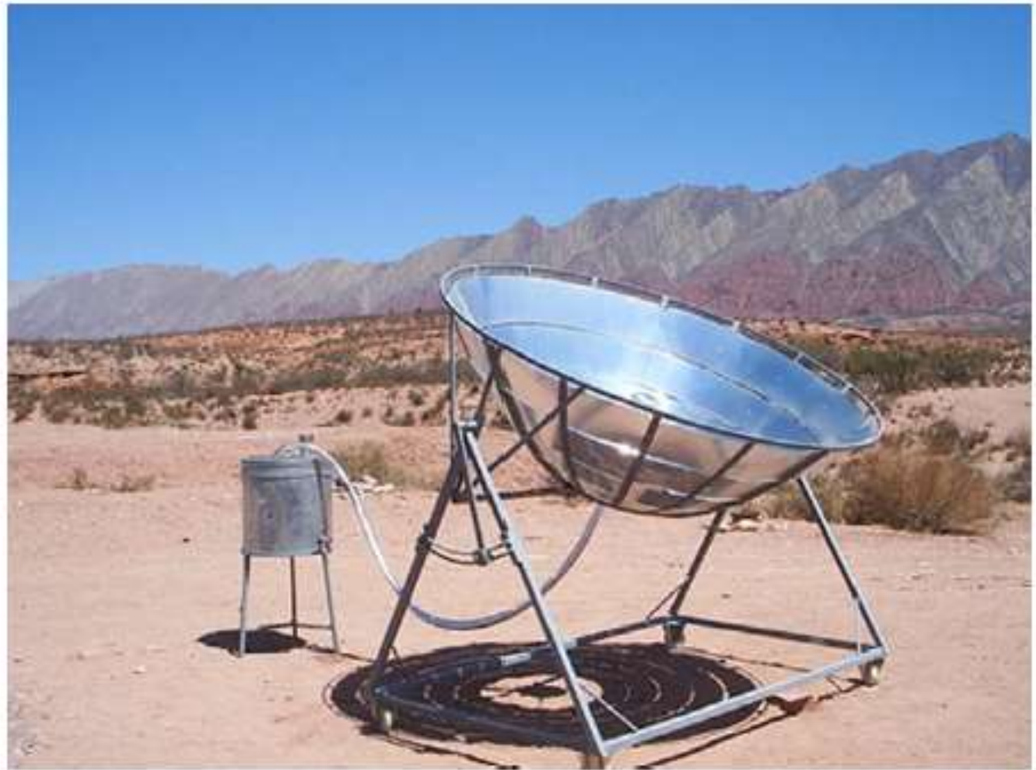
شكل (5-6): جهاز بستره حليب الماعز بالطاقة الشمسية باستخدام المبستر الشمسي المركز. (Franco et al., 2004)
