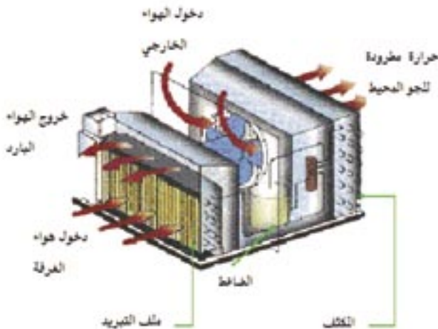
شكل ٧-٣ رسم تخطيطي لوحدة تكييف شباك
