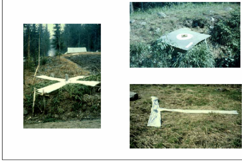
شكل (٥-١٧) علامات أرضية اصطناعية
