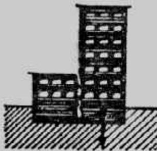
٤- تنفيذ مبان صغيرة ملاصقة لمباني عالية (أساسات مفردة أو لبشة).
