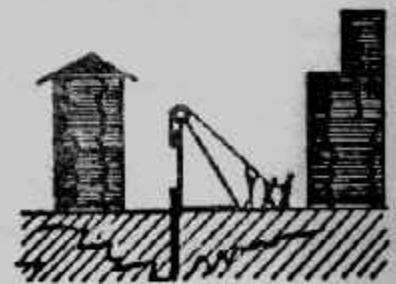
١٦- تدق خوازيق بجوار مبنى قديم.
