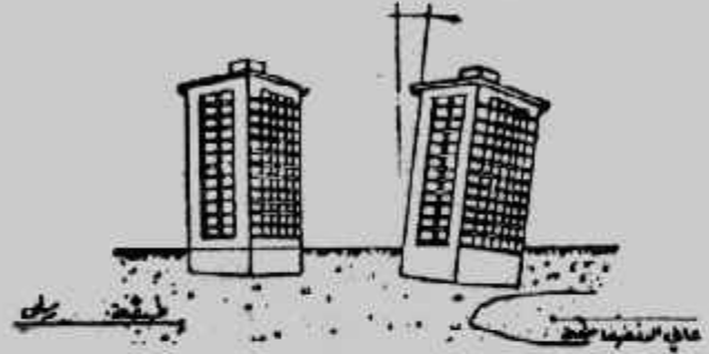
٦- تأسيس جزء من المبنى على ردم أو تربة ليئة أو عضوية .
