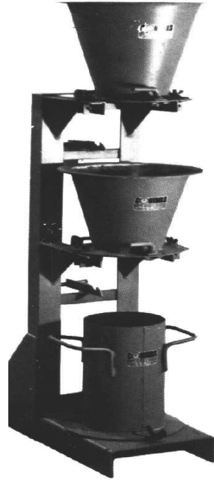
شكل (٧-٢): جهاز اختبار معامل الدمك.
