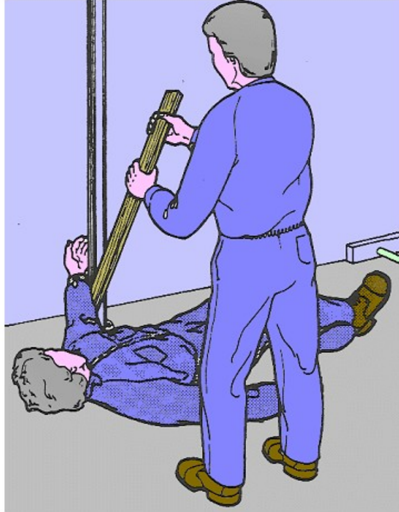
الشكل (١- ١٠) يبين طريقة فصل المصاب عن التيار عن طريق استخدام عصا عازلة
