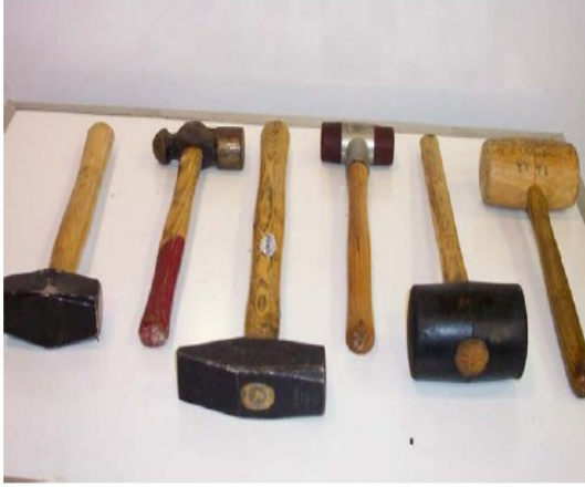
الشكل (٣- ١٥) يبين الأشكال المختلفة للمطارق التي يستخدمها الفني في ورشة صيانة المركبات
