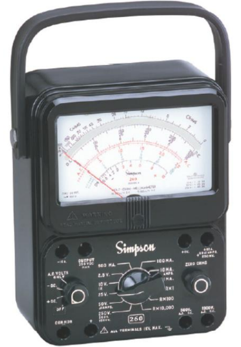
شكل ١٦ مقياس تناظري فولت أوم ملي أمبير (VOM)
