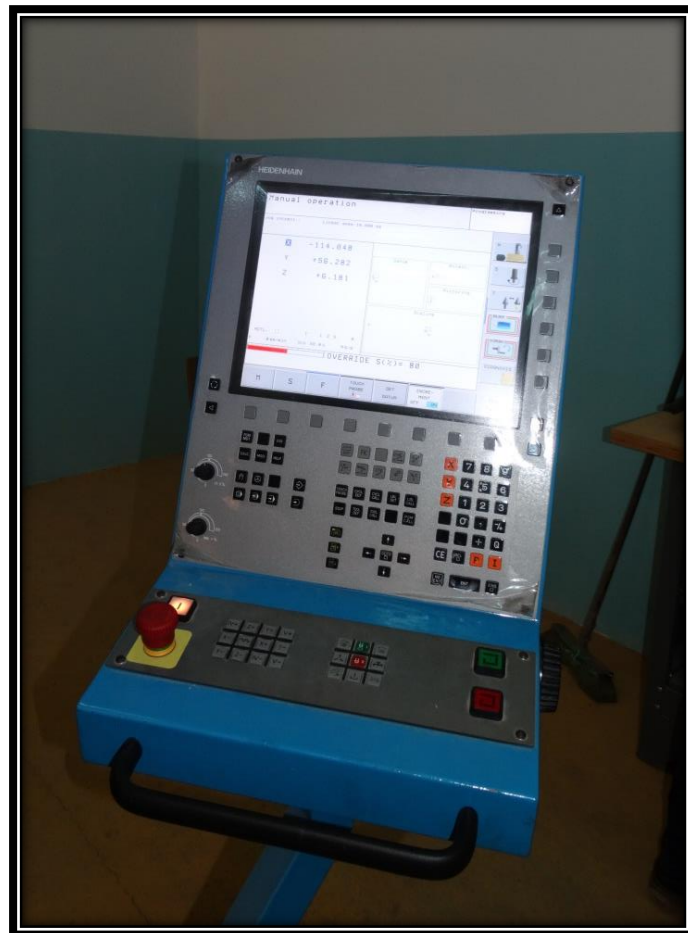
صورة توضح لوحة التحكم لآلة CNC
