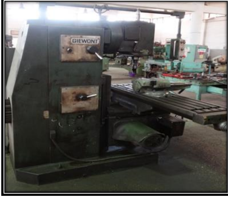
شكل (6.4) يوضح الشكل العام لآلة التفريز
