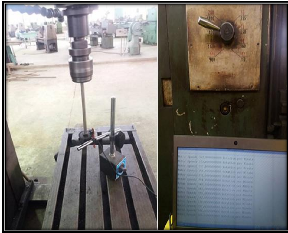
شكل (8.4) يوضح توصيل الجهاز المقترح بالحاسوب على آلة التفريز
