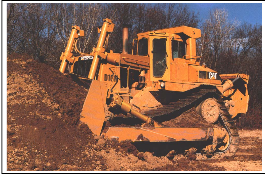
شكل (٣ - ١٧) : أحد أنواع معدات الإزاحة المجنزرة
